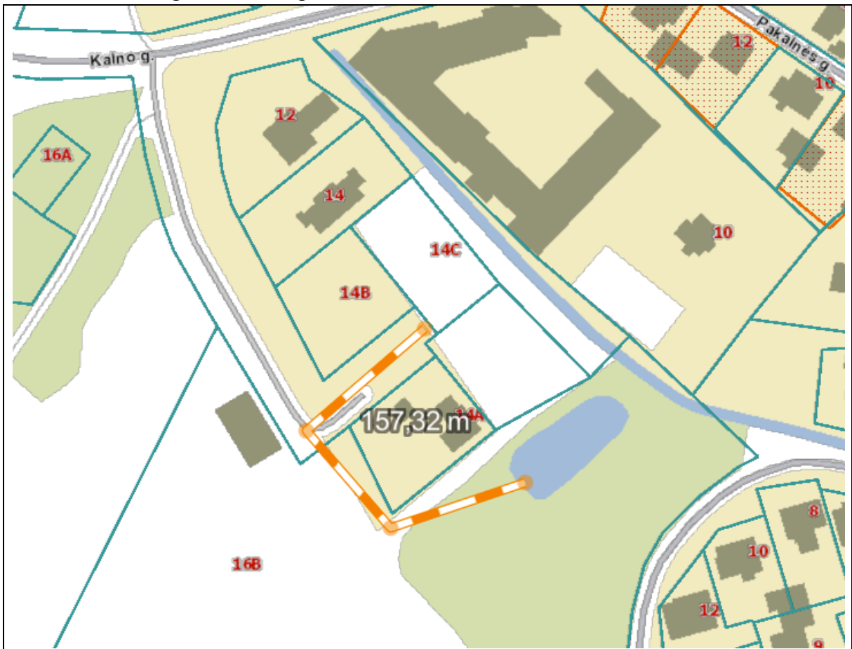
4 pav. Privažiavimo prie priešgaisrinio vandens rezervuaro schema
